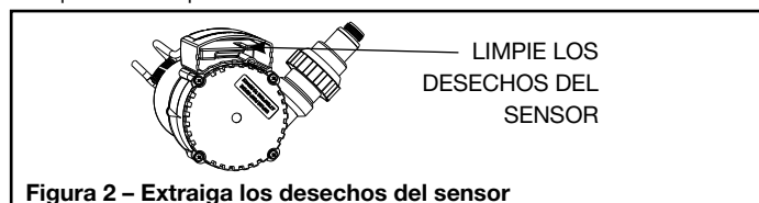
Figura 2 – Extraiga los desechos del sensor
