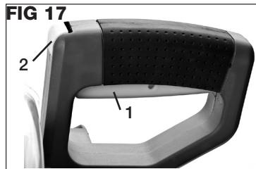
**ADVERTENCIA:** Despues de realizar un corte, libere el gatillo del interruptor para activar el freno eléctrico de la hoja. Mantenga abajo la cabeza de corte hasta que la hoja se detenga completamente antes de levantar la cabeza de corte a la posición arriba o posición de arranque. Una hoja en rotación puede ser peligrosa.
