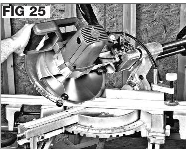
et vice versa. Il peut falloir de nombreux réglages et de nombreuses coupes d'essai pour obtenir le résultat voulu. Quand des coupes combinées sont nécessaires sur un projet, les réglages sont en général fournis, issus de manuels spécialisés avec des paramètres calculés à l'avance, des tableaux publiés, etc. Aussi vous pouvez vous référer au tableau à Coupe d'onglets Composés incluses dans le manuel.
