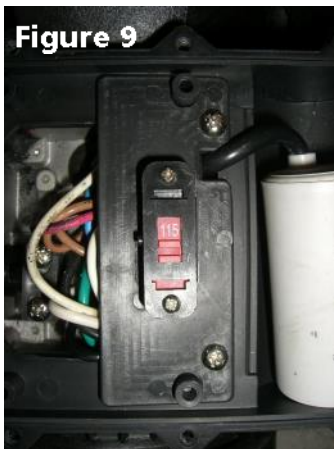
Figure 9 Le commutateur de tension est réglé d'usine à 115 volts.
